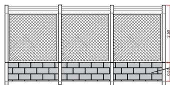
Mureta em Alvenaria de Tijolo Cerâmico
